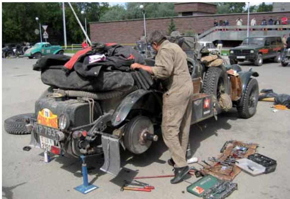
Russland, Bijsk (erste Übernachtung nach der Mongolei, Südsibirien). Hansruedi Portmann ersetzt einen Bolzen (Stahl, 12 mm), den es abgeschert hat und der den Reibungsdämpfer hinten rechts befestigte.
