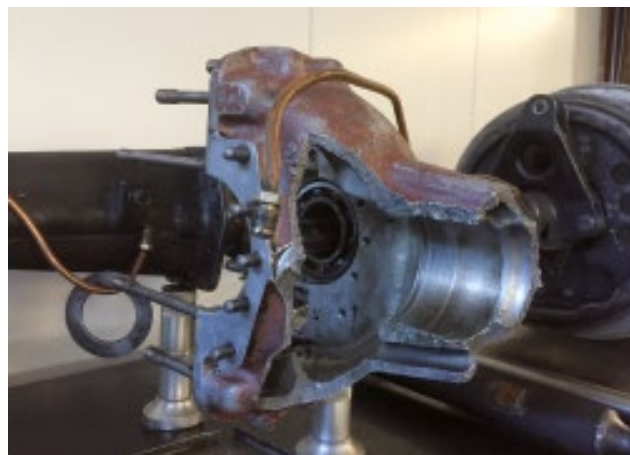
Dieses Differentialgehäuse wurde 3-D eingescannt und die Gussform erstellt, anschliessend wird das neue Gehäuse gegossen.
