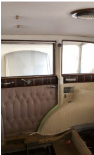
Isotta Fraschini 1929, der Himmel und der hintere Teil sind fertig .
