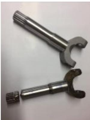
Steckachse zu Traktor (Vorderachse).
