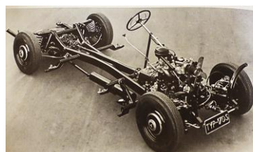
Telaio a longheroni ovali motore e cambio anteriori trazione posteriore
