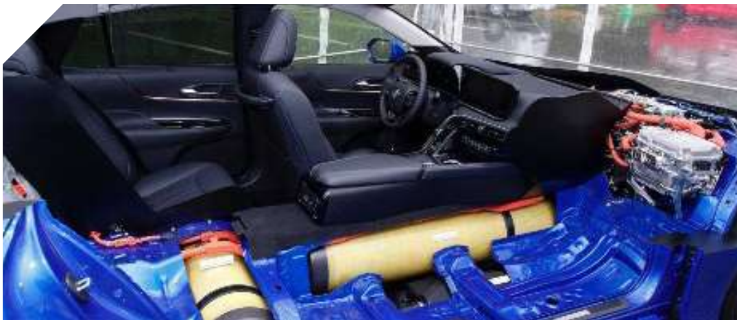
Spaccato di una Toyota Mirai, con i serbatoi dell'idrogeno a 700 bar posti sotto l'abitacolo.
