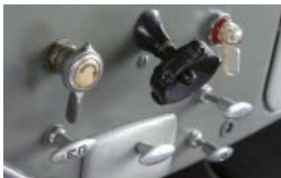
Das Armaturenbrett eines Citroën Traction Avant der Modelle 1BN, 11BL und der 15-6 aus den 1950er Jahren. Diese Hebel, Knöpfe, Schalter werden auf vielfältige Art und Weise bewegt. Man dreht oder zieht diese: Link zur Beschreibung: <https://is.gd/hw4k7A>
